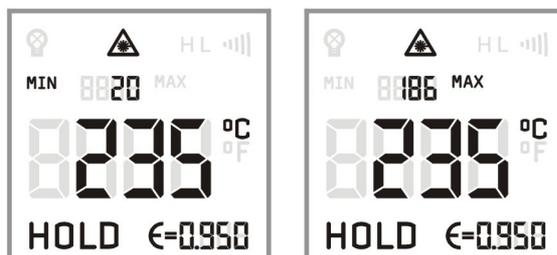
MIN 表示本次测量的最小值，MAX 表示本次测量的最大值。
